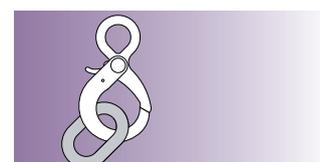
☞ **Mailles de tête :** La maille de tête de l'élingue doit se placer facilement sur le crochet de l'appareil de levage et jouer sur celui-ci. Elle ne doit jamais se coincer sur le crochet. Protéger la maille contre les appuis sur arêtes vives et veiller à ce qu'elle ne subisse pas d'efforts de flexion
