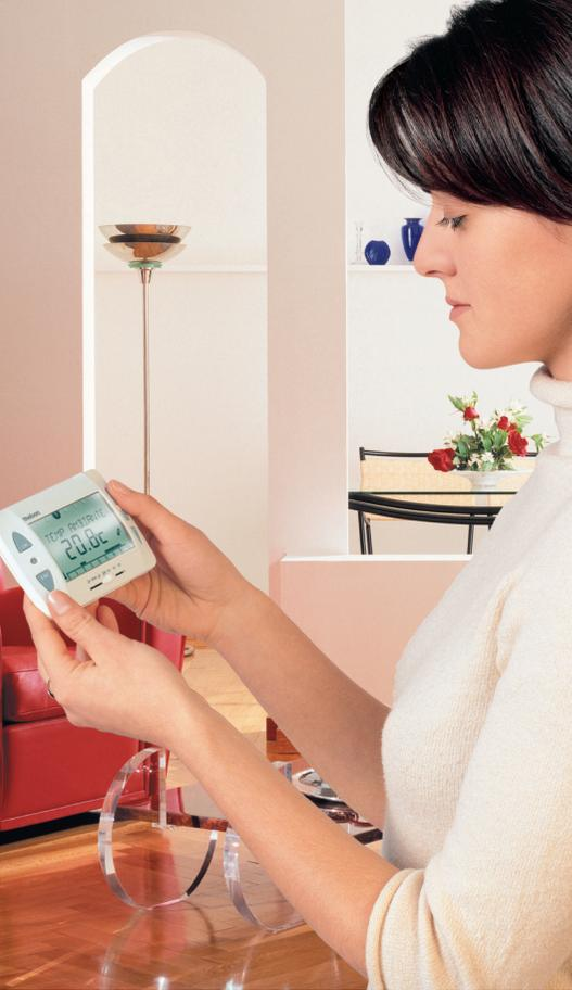
**Le thermostat programmable permet la programmation journalière et hebdomadaire du chauffage selon une plage de réglage comprise en 7 et 35° C (7 et 30° C pour le chauffage au gaz et les planchers chauffants).**
