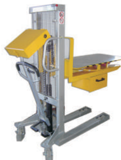
DDZZ0098 : Gerbeur avec plateau rotatif indexé sur mesure pour changement d'outils sur presse. Tiroir à outils et coffre pour PC portable.
