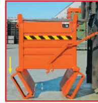
Fermeture de la benne par pose au sol.
