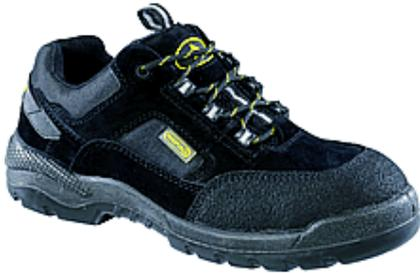
Semelle anti-perforation S1P, antistatique et amagnétique. Embout **composite** 200 J : Plus léger que l'acier, non conducteur chaud/froid.
