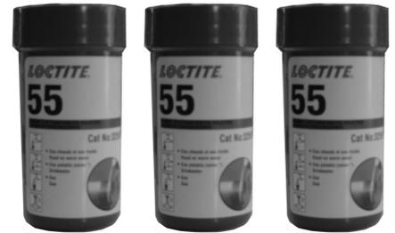
Ce nouveau matériau « prêt à étancher » vous permet d'obtenir une étanchéité immédiate et durable. Remplace la filasse. Quelques secondes suffisent pour appliquer la fibre sur le filetage du tube. Résiste aux pressions jusqu'à 16 bars, à la chaleur (130°), aux coups de bélier et aux vibrations. Conforme aux nouvelles normes européennes (EN751-2 Arp reconnu par l'AFNOR). Efficace sur les raccords métalliques et plastiques jusqu'à 150 mm de diamètre.
