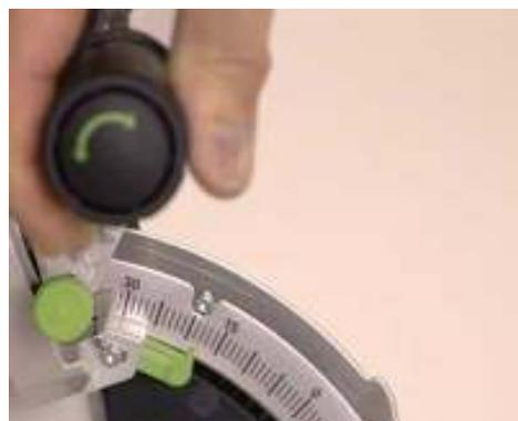
Réglage fin en face avant et blocage rapide
