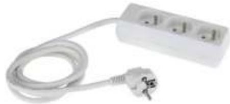
2P+T 16A avec 1,5m câble H05VVVF 3G1,5mm<sup>2</sup> avec éclipses de protection enfant. 3500W. NF CE
